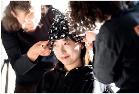
Akina Fukushima-Maekawa beim Setup: Die fNIRS-Kappe wird angepasst und die Signalqualität der Optoden geprüft
