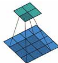
Ein konvolutionärer Kern (dunkelblau) wird auf die Eingabe (blau) angewendet, um die Ausgabe (cyan) zu erzeugen
